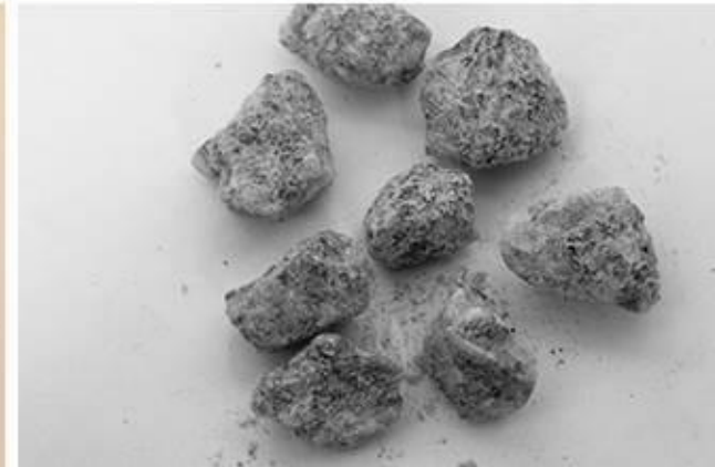
0/8 mm høykvalitets knust sand: optimalisert knusing, VSI knusing & vasking/ vind- sikting
