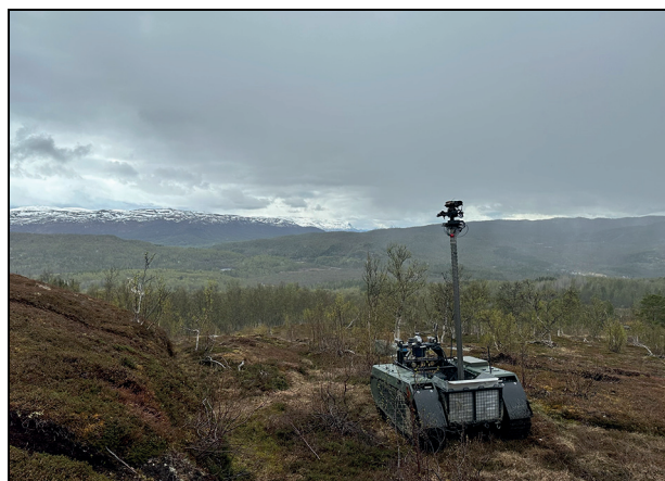
Figur 9.12 Et ubemannet kjøretøy, som har kjørt autonomt ut til et aktuelt område, og deretter blitt fjernstyrt til en gunstig posisjon i terrenget.
